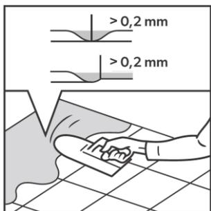
Цементные швы между плитками или другие зазоры более 0,2 мм должны быть выровнены.
