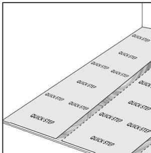
3.3 Следите за тем, чтобы полосы подложки при укладке не накладывались одна на другую. Они должны быть уложены идеально прилегающими друг к другу краями. Снимите защитную пленку с клейкой полосы первого ряда и наклейте фольгированную кромку второго ряда поверх первого. Убедитесь в том, что ряды подложки плотно прилегают друг к другу и что кромка приклеена правильно.
