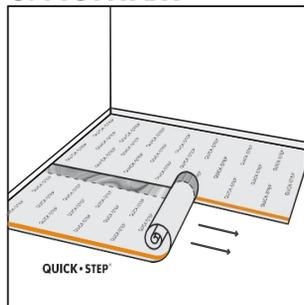
3.1 Разверните подложку логотипом вверх. Перед отрезанием подложки по размеру убедитесь в том, что она расположена стык в стык к стене. С целью гидроизоляции мы рекомендуем заводить подложку на стену на 1 см или использовать ленту из полиэтиленового уплотнителя.
